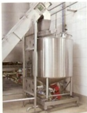
Der High-Speed-Mixer UR600 zerkleinert fortlaufend Restbrot oder Restteige.
